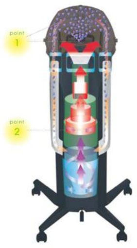
※オゾン発生装置の寿命は約1000時間(約4000人)が目安です。表示パネルに「AL」が点灯し、交換時期をお知らせします。
