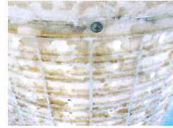
洗濯槽内面写真 全自動洗濯機10年使用
